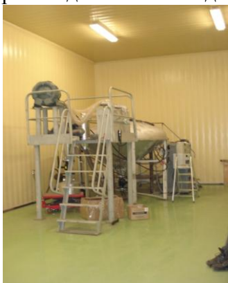
Рис. 6. Установка центробежного распыления компании PCT.
