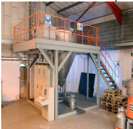
Рис. 4. Установка центробежного распыления компании ASL.
